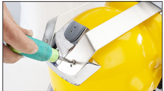
Vuelva a instalar los dos tornillos y arandelas en el contrapeso superior.
