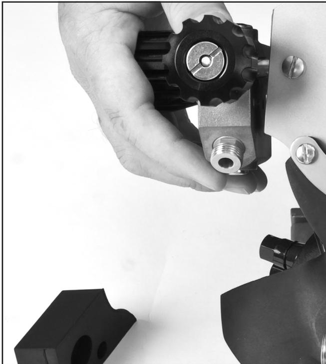
Instale el bloque lateral en el armazón del casco.
