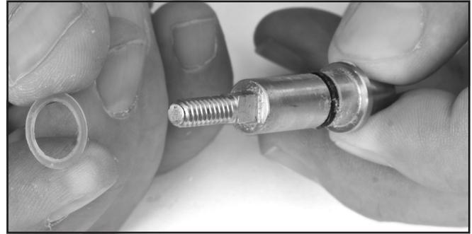
*Instale la arandela en el vástago de la válvula del desempañador.*
