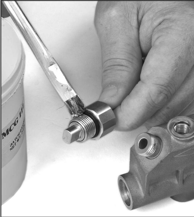
*Antes del montaje, asegúrese de lubricar todas las piezas, a excepción del asiento de la válvula.*
