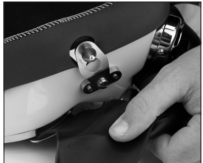
Para acceder a la guarda de la banda inferior para ajustarla, debe desplazar la bigotera.
