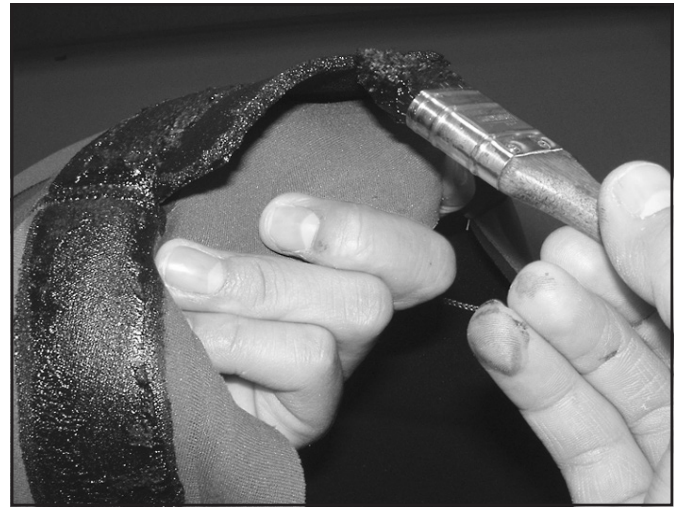
Aplique adhesivo a los bolsillos para los auriculares y los bordes de las solapas de los bolsillos.
