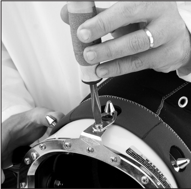
Ajuste de la guarda de la banda superior
