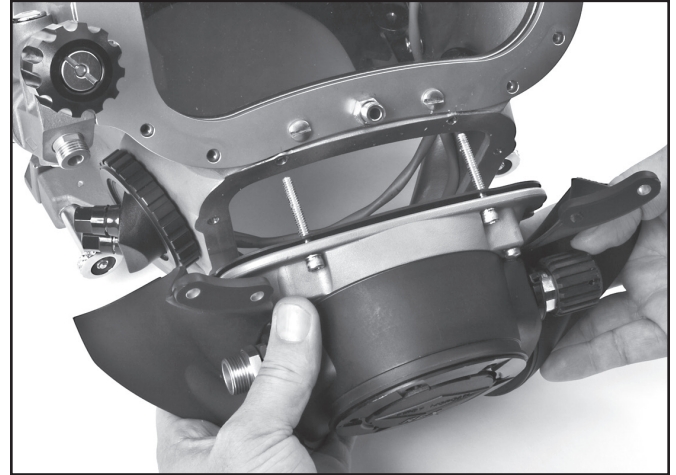
Separe el conjunto del regulador y la carcasa del armazón del casco.
