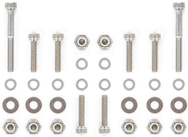
**NOTA:** la carcasa se sujeta al casco por medio ocho tornillos con tuercas de seguridad. Seis de los tornillos se colocan con una arandela diferente de cada lado de la carcasa: la arandela delgada debe instalarse en el exterior (lado de la cabeza hexagonal) y la arandela gruesa del lado interior (lado de la tuerca).
