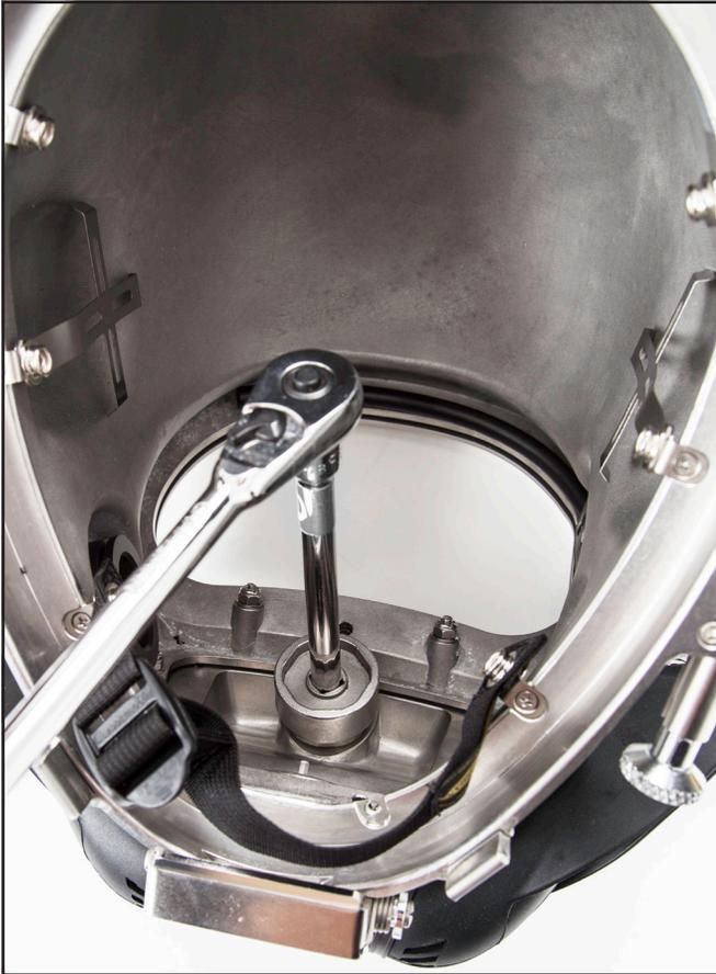
*Ajuste la tuerca de montaje del regulador. Consulte el módulo "Pares de apriete." Use una llave dinamométrica para garantizar el ajuste correcto.*
