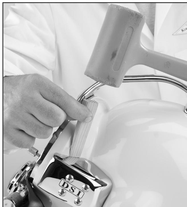
*Use una cuña de madera y un mazo para romper el sello entre el contrapeso y el armazón del casco. **NO USE UN DESTORNILLADOR NI UN CINCEL O FORMÓN PARA SEPARAR EL CONTRAPESO.** Podría dañar el armazón del casco, y la reparación es costosa.*
