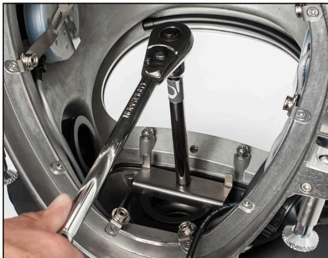
*Ajuste la tuerca de montaje del regulador. Consulte el módulo "Pares de apriete." Use una llave dinámica para garantizar el ajuste correcto.*
