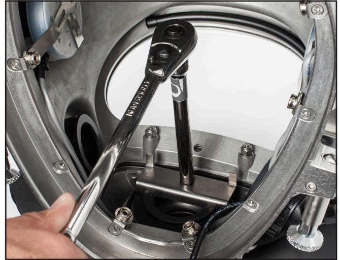
*Cuando haya terminado la instalación, asegúrese de ajustar la tuerca de montaje del regulador según el par de apriete especificado. Consulte el módulo "Pares de apriete."*
