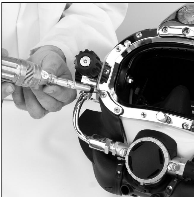
*Ajuste los tornillos que sujetan las bigoterías al casco. Consulte el módulo "Pares de apriete."*
