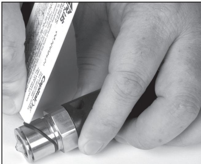
*Retire la junta tórica de la tuerca de presión de la perilla flexible. Puede usar una tarjeta de crédito, un mondadientes o cualquier elemento suave que no dañe la junta tórica ni la tuerca.*
