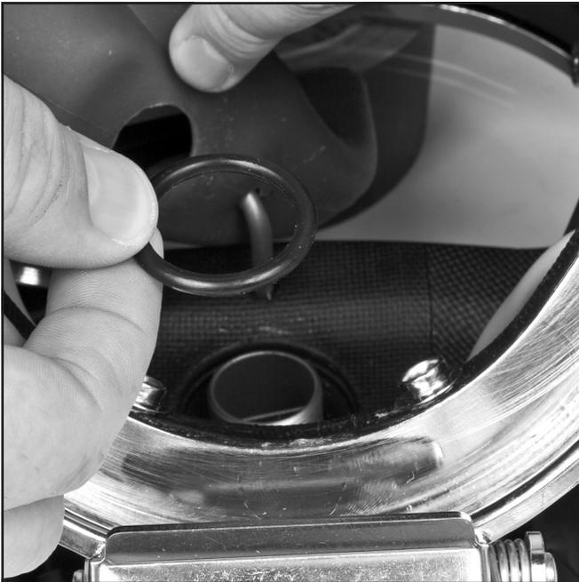
*Instale la junta tórica que se ubica en el tubo del regulador dentro del casco.*
