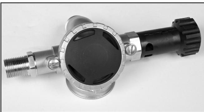
**NOTA:** al guardar el casco durante cualquier período de tiempo, asegúrese de girar completamente la perilla flexible “hacia afuera” en sentido antihorario, para evitar tensionar el resorte de compensación. Esto prolongará la vida útil tanto de la válvula de entrada, como del asiento y del resorte de compensación.
