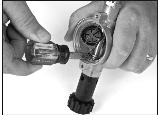
*Asegúrese de que horquilla de retención se acople completamente a la tuerca de presión.*
