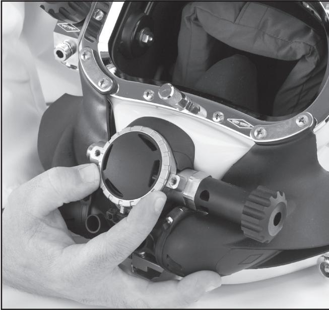
*Desenrosque el anillo de sujeción de la cubierta y retire la cubierta.*
