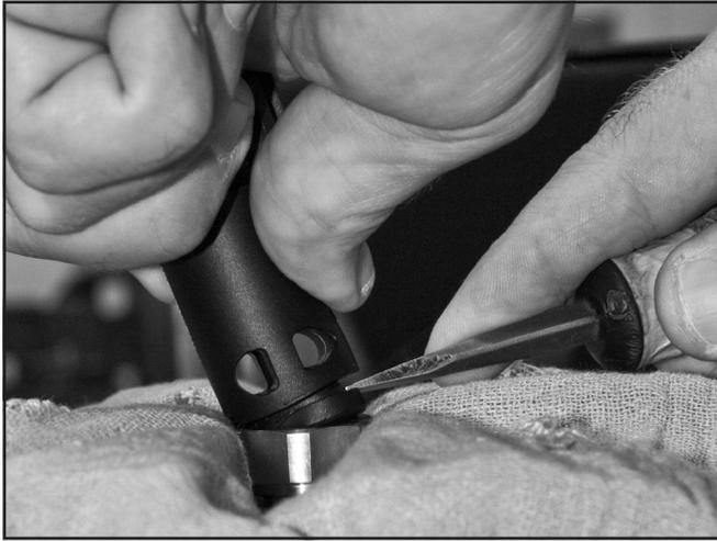
*Coloque la tuerca de presión en un tornillo de banco y use un destornillador de cabeza plana para insertar la perilla flexible.*
