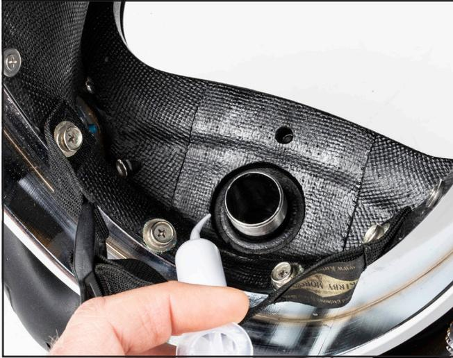
3) Revise la tuerca de montaje del regulador para comprobar que no presente indicios de daño ni contaminación. Use un cepillo de dientes para limpiar las roscas según sea necesario. Aplique un poco de lubricante Christo-Lube® a las roscas del tubo de montaje del regulador y a la junta tórica de sellado.
