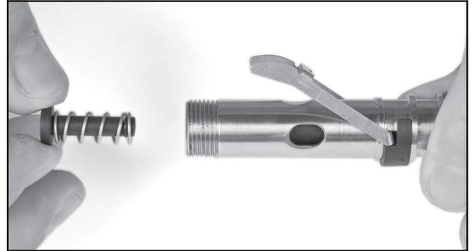
*Inserte el espaciador de compensación y el resorte en el tubo principal. Cuando se instala correctamente, el espaciador se acopla a la válvula de entrada.*
