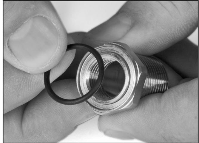
*Instale la junta tórica en el adaptador del tubo curvado.*
