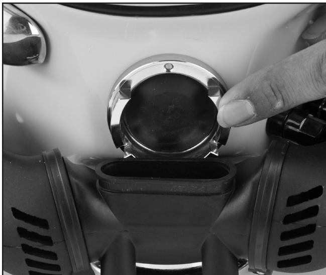
*Debe retirar la cubierta de vaciado de agua con acople para revisar la válvula de vaciado de agua.*
