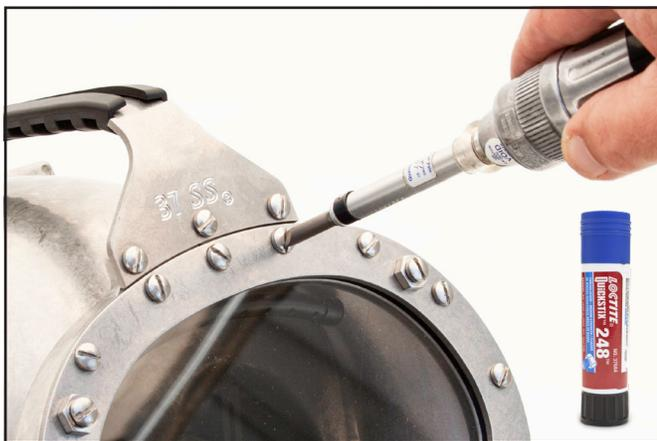
*Use siempre un destornillador dinamométrico para verificar la tensión de los tornillos del marco de retención del visor.*
