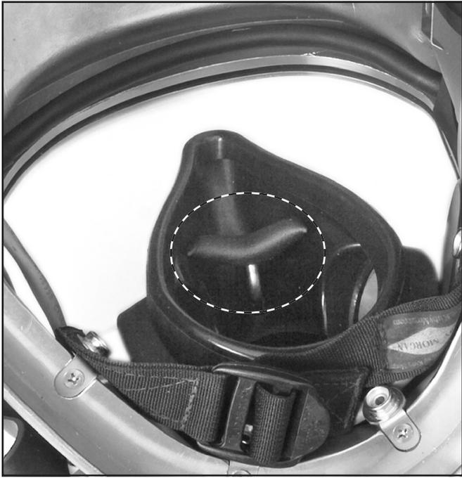
*Bloqueador nasal instalado correctamente.*
