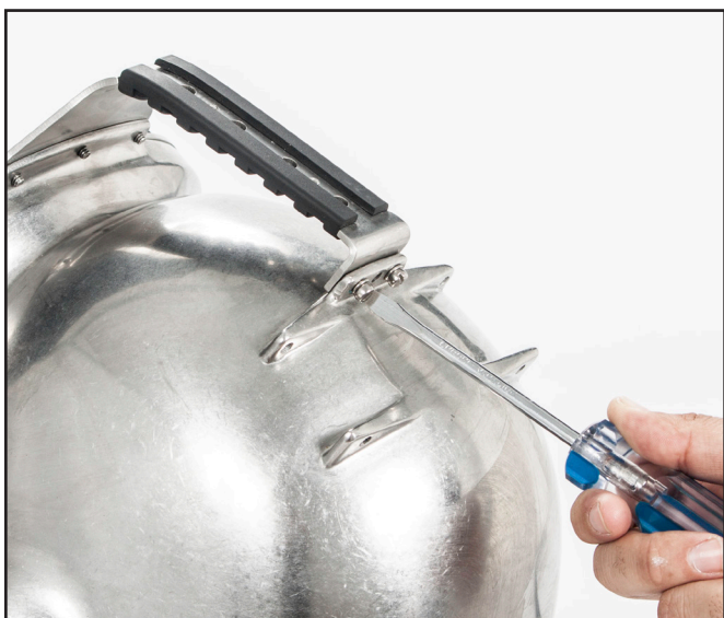
Retire los tornillos de la parte trasera de la agarradera.
