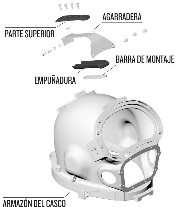
Vista despiezada de la agarradera y el armazón del casco
