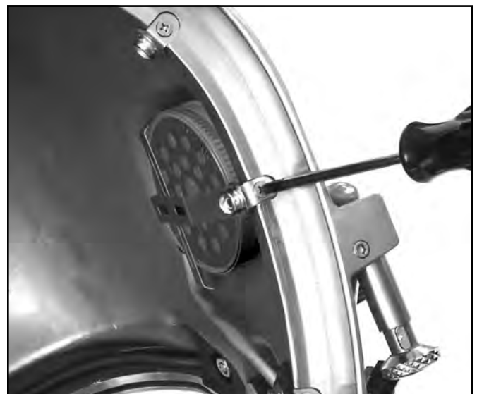
Desmontaje de la lengüeta con broche de presión que sujeta también la abrazadera en cruz de uno de los auriculares.
