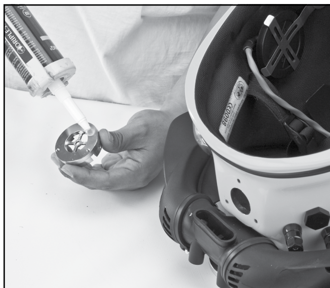
Para sellar el espacio entre el cuerpo de vaciado de agua y el armazón del casco se utiliza sellador de silicona.
