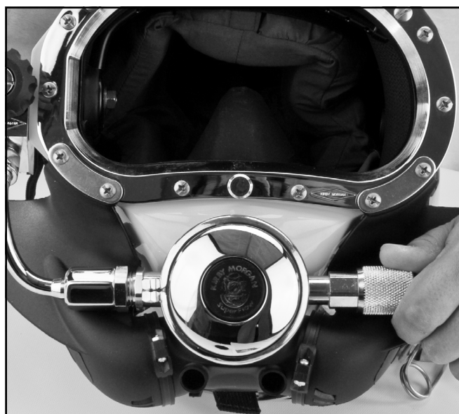
El regulador debería comenzar a producir un flujo libre una vez que se haya girado la perilla de ajuste varias veces hacia afuera.
