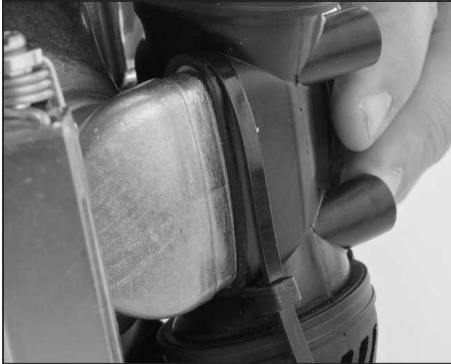
Inserte el regulador en la carcasa.
