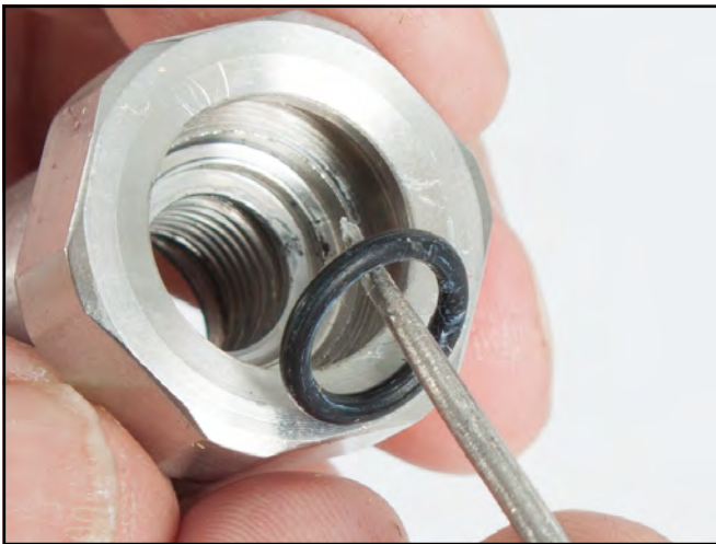
Con un extractor de juntas tóricas, retire cuidadosamente la arandela de apoyo y la junta tórica de la varilla de ajuste.
