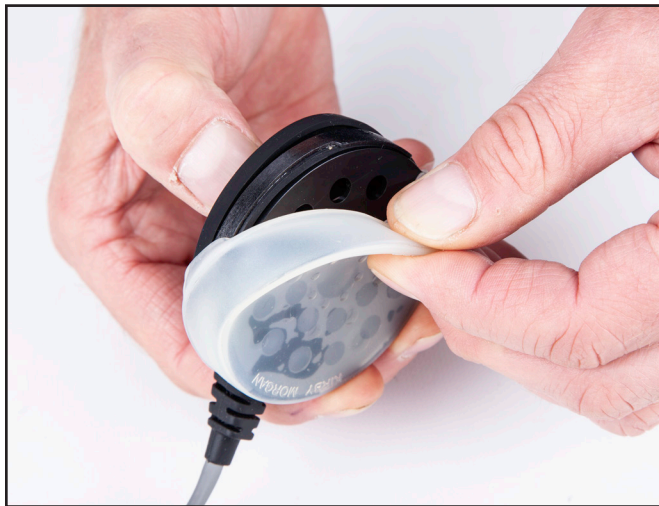
Retire la tapa de caucho del auricular.
