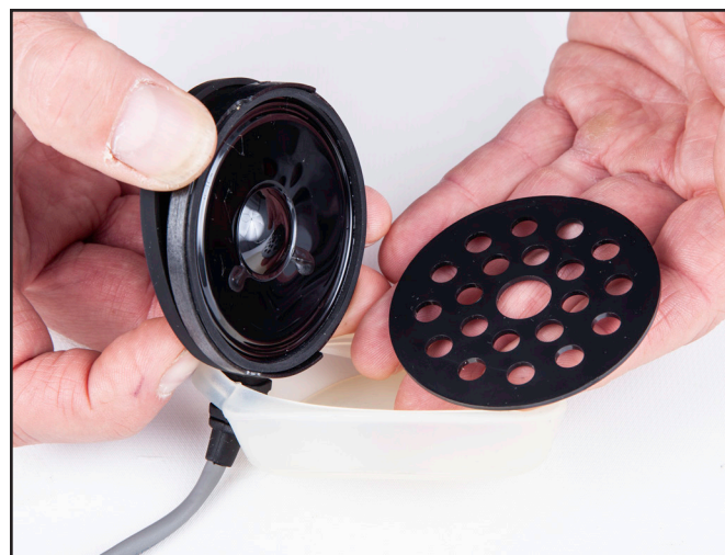
Destape los auriculares para que se sequen.
