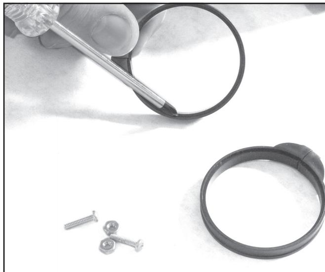
*Note que el interior de las abrazaderas de bigotera tiene una superficie escalonada. Las abrazaderas deben estar orientadas en la posición correcta para retener la bigotera de manera adecuada: el escalón inferior debe apuntar al regulador.*
