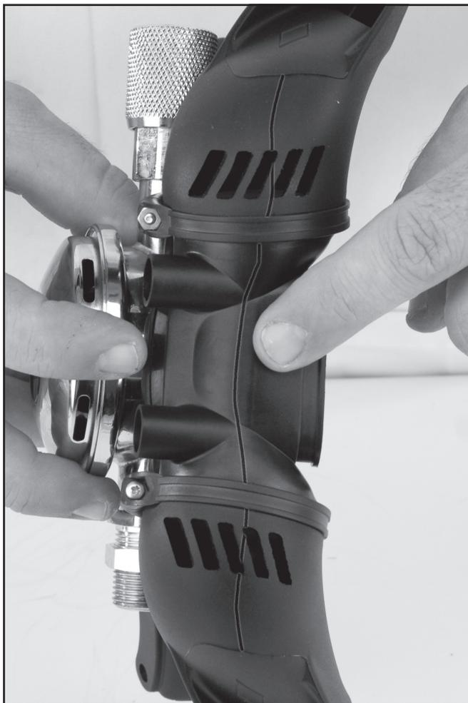
*Observe la posición correcta de la línea de moldeo que recorre las bigoteras y el cuerpo principal del sistema de escape.*
