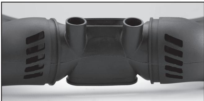
*Las bigoteras deben quedar alineadas correctamente con el cuerpo principal del sistema de escape.*
