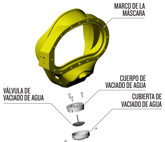
*Conjunto de cuerpo, válvula y cubierta de vaciado de agua de la máscara KMB 18.*
