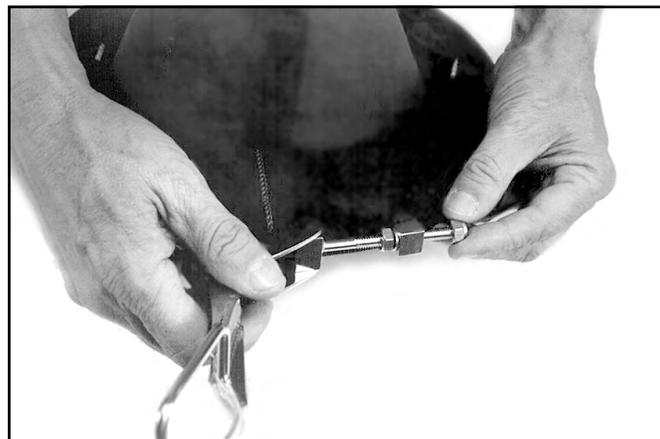
*Inserte el perno de ajuste en el bloque y enrosque la tuerca.*
