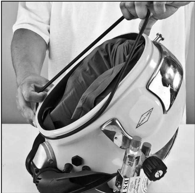
*Reemplace la junta tórica de la base del casco una vez al año o cada vez que observe indicios de desgaste.*
