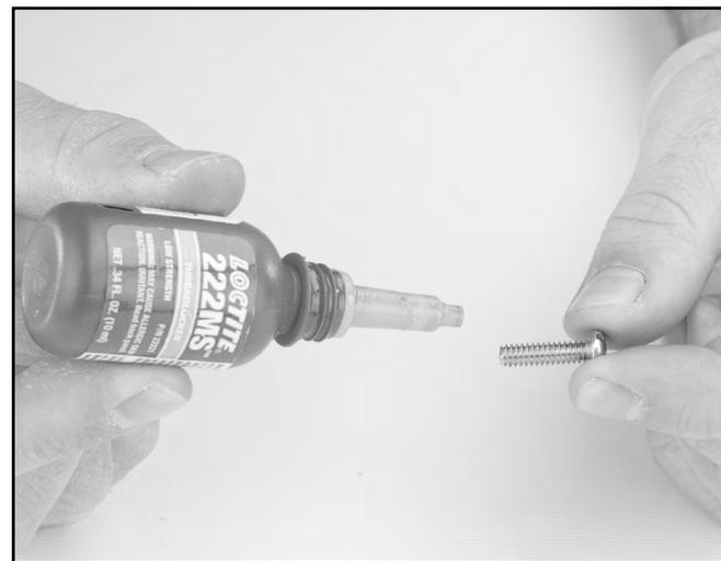
*Aplique fijador de roscas Loctite® a los tornillos que sujetan el conjunto del seguro a la horquilla.*
