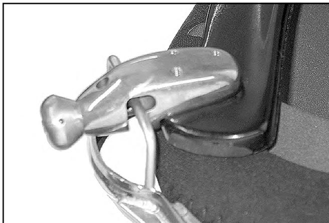
*Cuando el conjunto de la abrazadera del cuello está ajustado de forma correcta y en posición cerrada, el fiador debe quedar perfectamente apoyado en la ranura del cuerpo del seguro.*
