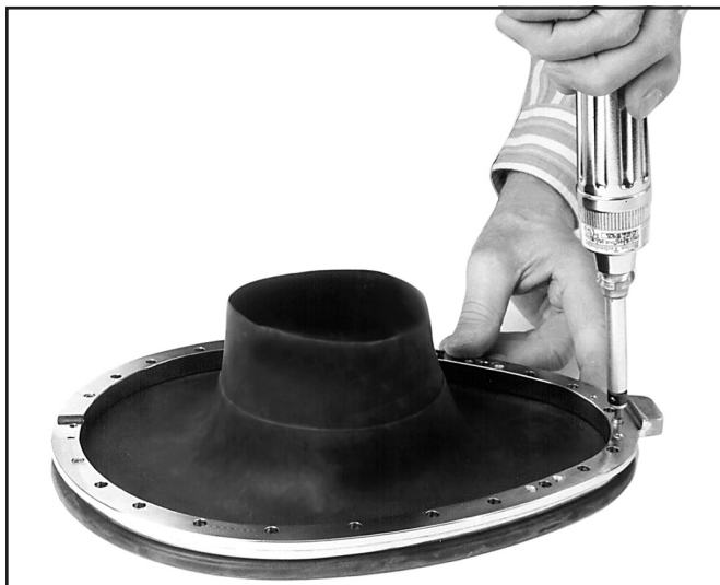
Perfore el cuello de contención con los tornillos.
