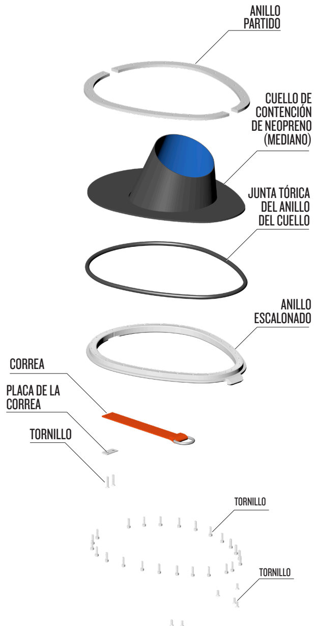
Vista despiezada del conjunto de anillos del cuello del casco
