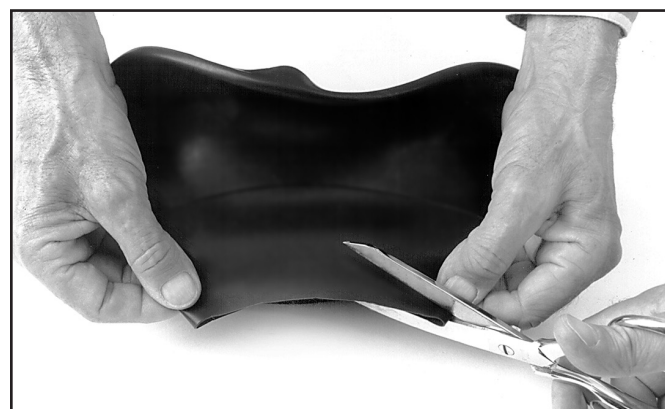
Recorte el cuello de contención de látex con las tijeras más grandes y afiladas que pueda conseguir.
