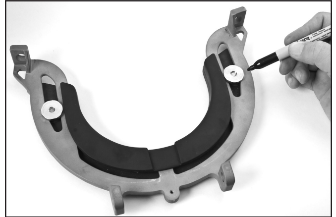
Antes de desmontar el collar de sujeción, marque la posición de las arandelas.
