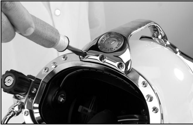
Desatornille los tres tornillos superiores del marco de retención del visor.
