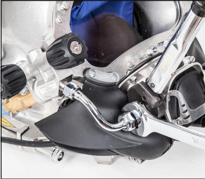
*En los reguladores compensados SuperFlow® 450 y 455, ajuste la contratuerca contra la tuerca de montaje del tubo curvado. Consulte el módulo "Pares de apriete."*
