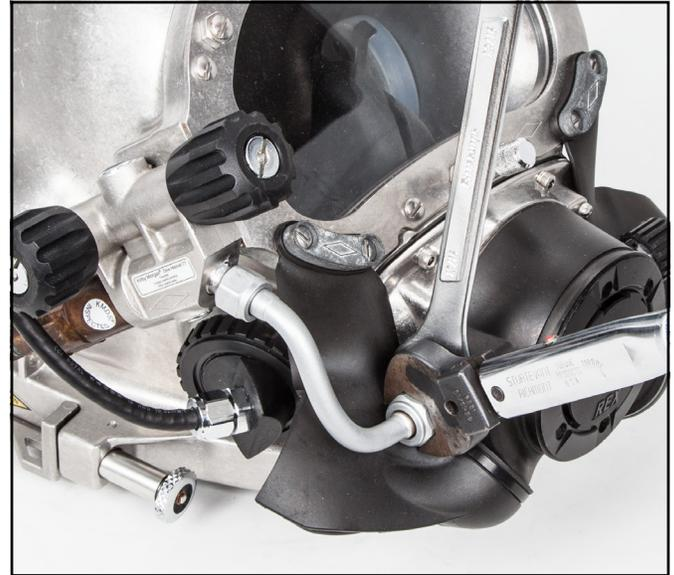
*En el caso del regulador REX, ajuste la tuerca del tubo curvado contra la tuerca hexagonal del tubo de la boquilla. Consulte el módulo "Pares de apriete."*
