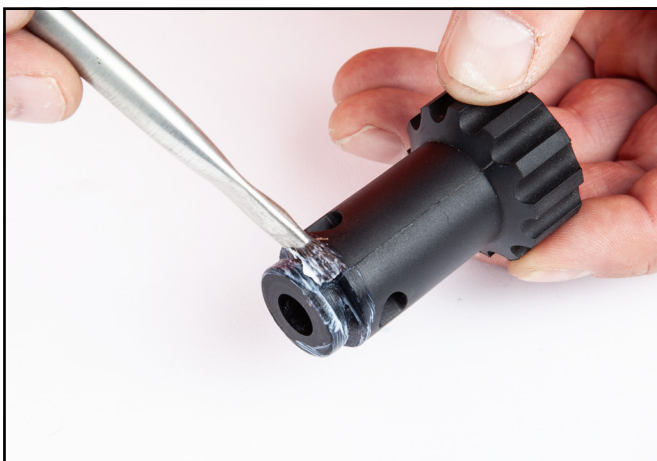
Aplique un poco de lubricante en la ranura del extremo de la perilla flexible.
