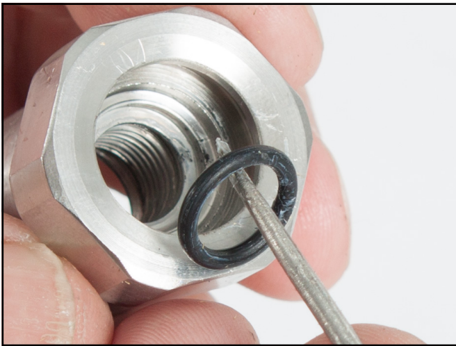
Con un extractor de juntas tóricas, retire cuidadosamente la arandela de apoyo y la junta tórica de la varilla de ajuste.
