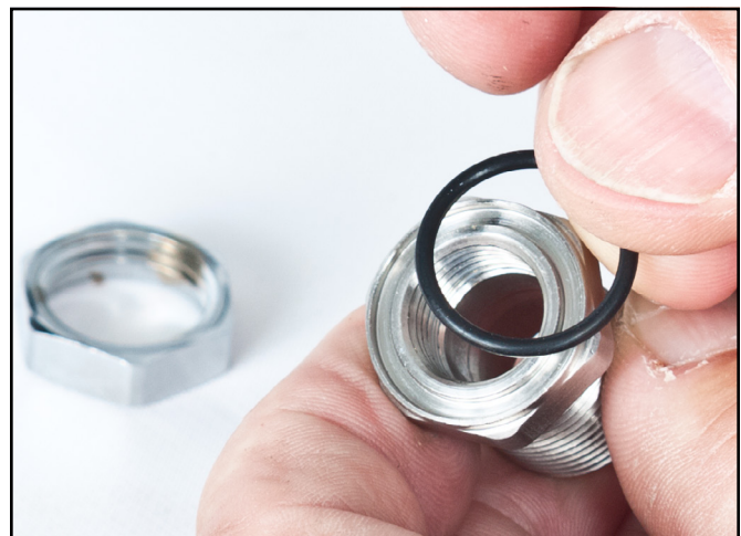
Instale la junta tórica en el adaptador del tubo curvado.
