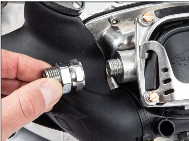
Retire el adaptador del tubo curvado.
