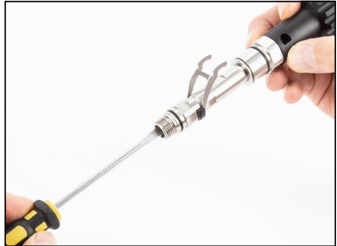
Con un destornillador de cabeza plana, enrosque lentamente la boquilla en el tubo.
