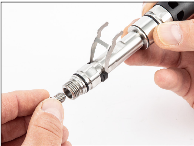
Instale la boquilla de ajuste en el tubo principal.
