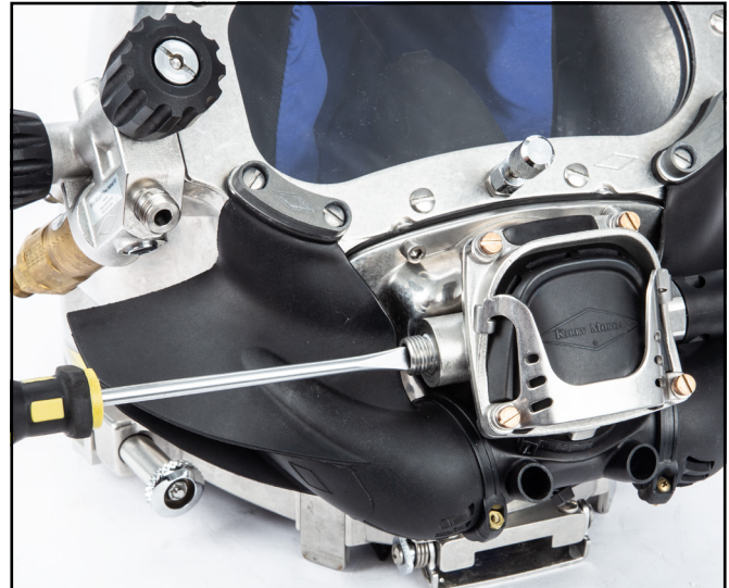
Gire la boquilla de ajuste 1/16 de vuelta por vez para ajustar el rendimiento del regulador.
