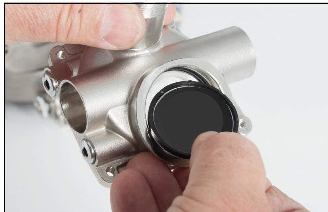
Instale la junta tórica y el asiento de la válvula.
