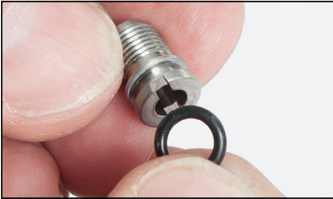
Instale la junta tórica en la boquilla de ajuste.
