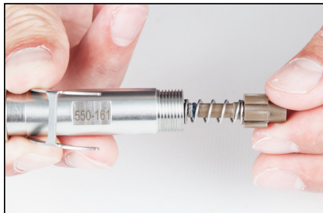
Instale el resorte y el espaciador de compensación con la junta tórica en el tubo principal.
