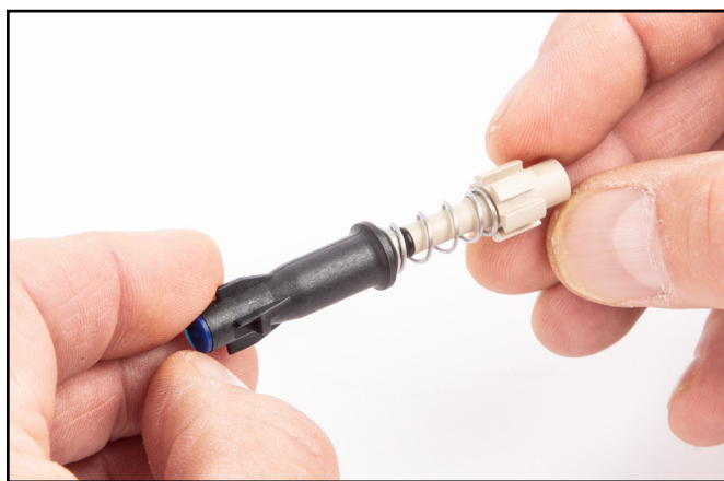
Introduzca el espaciador de compensación con la junta tórica instalada y deténgase cuando esta ingrese en el extremo abierto de la válvula de entrada.
