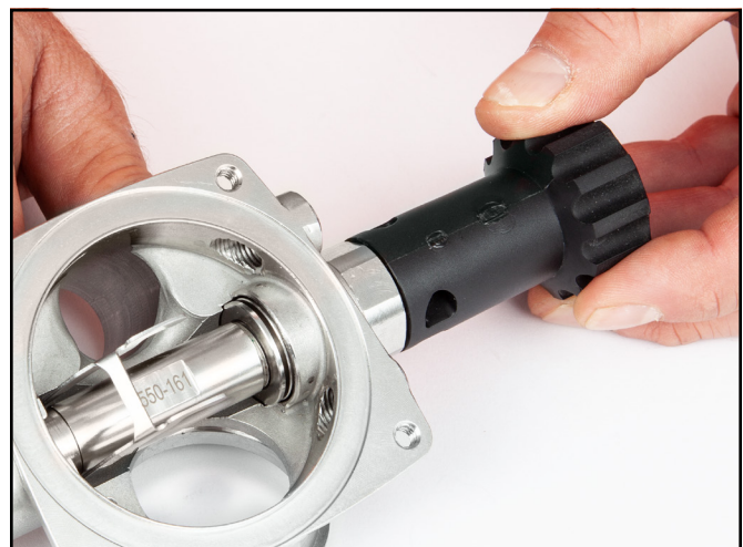
Gire la perilla flexible hacia adentro hasta que escuche un clic y luego hacia afuera tres vueltas completas.
