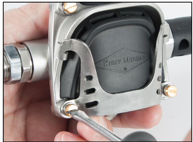
Instale el diafragma, el conjunto de la cubierta y los tornillos del marco de retención de la cubierta. Ajuste los tornillos según el par de apriete especificado.
