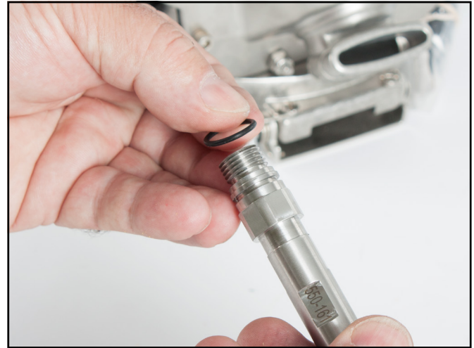
Retire la junta tórica del tubo principal.
