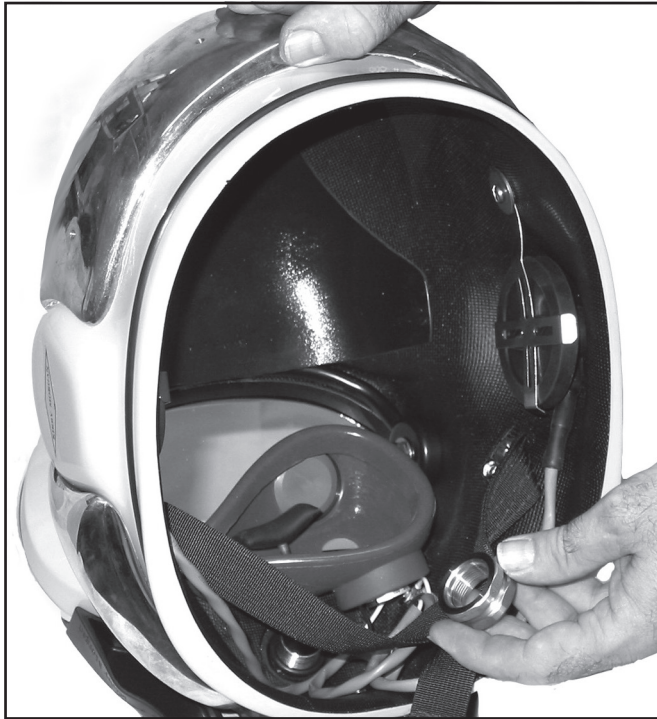
Retire la tuerca de montaje del regulador.
