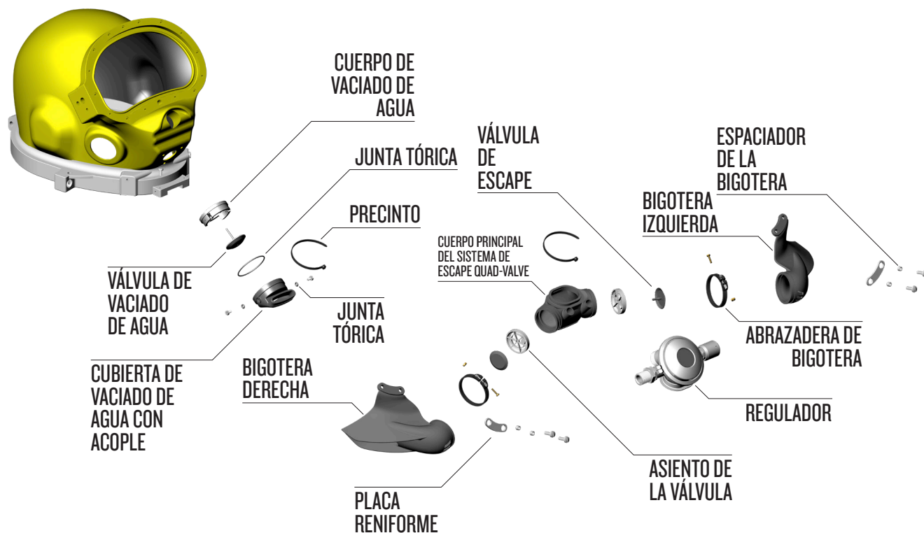
Vista despiezada del sistema de escape Quad-Valve
