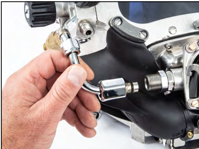
Retire el conjunto del tubo curvado.
