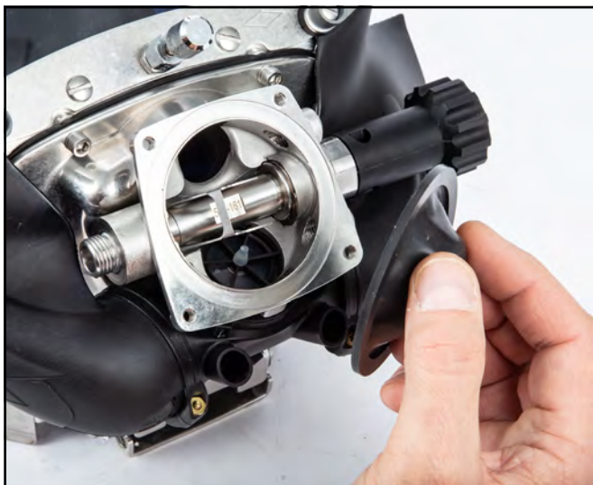
Retire el diafragma y revíselo bien. Si está roto o perforado, debe reemplazarlo.
