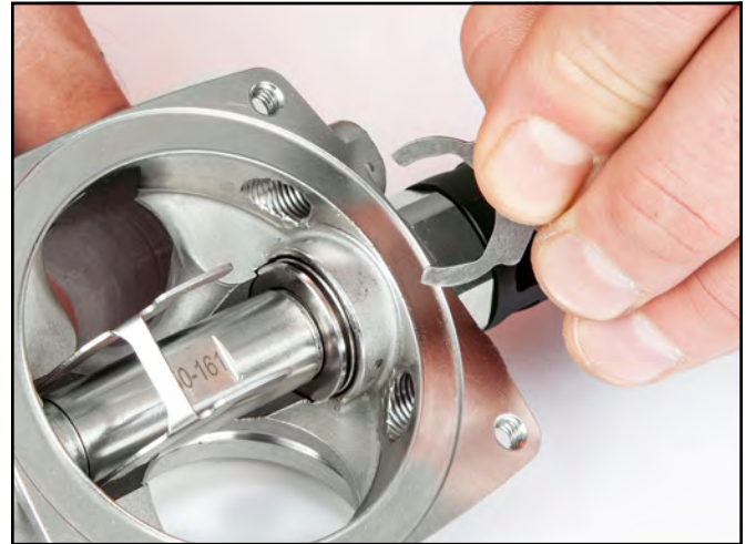
Instale la horquilla de retención en el tubo principal.
