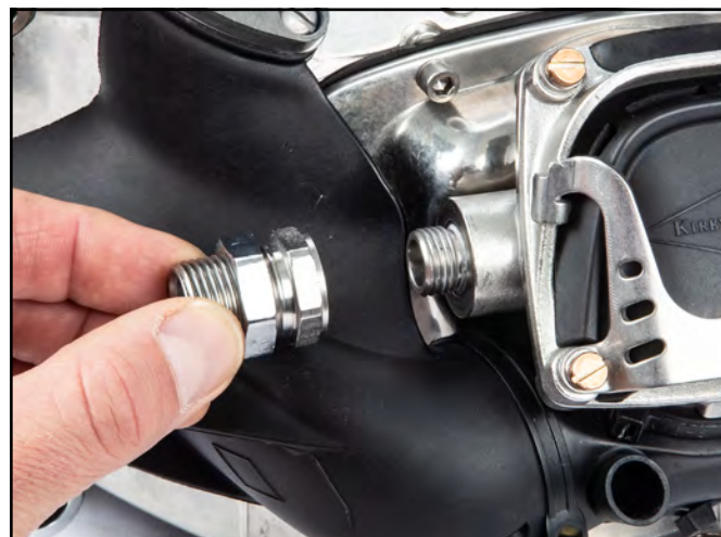
Retire el adaptador del tubo curvado.
