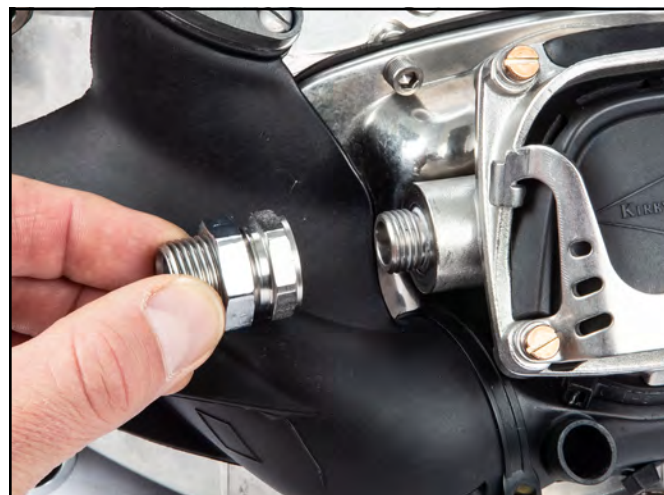
Retire el adaptador del tubo curvado y la junta tórica.
