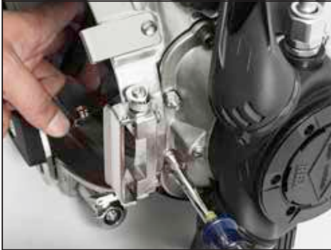
Las tuercas inferiores se colocan en el exterior de la carcasa.
