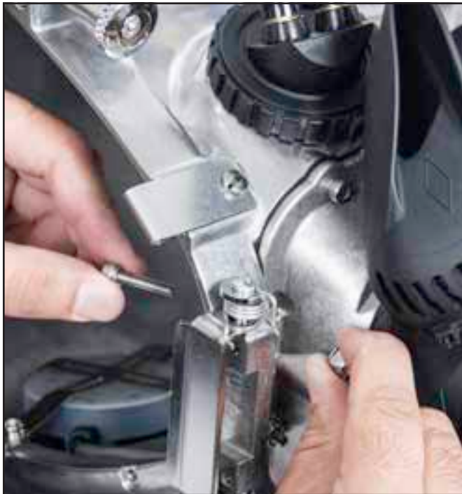
Las dos tuercas que van debajo del regulador se instalan en la parte exterior de la carcasa.
