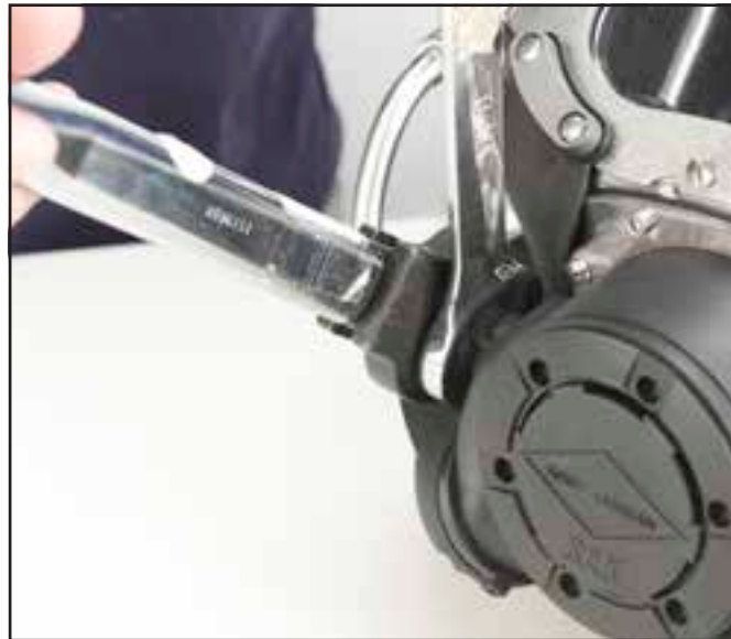
Asegúrese de que la conexión entre el tubo curvado y el regulador quede firme.
