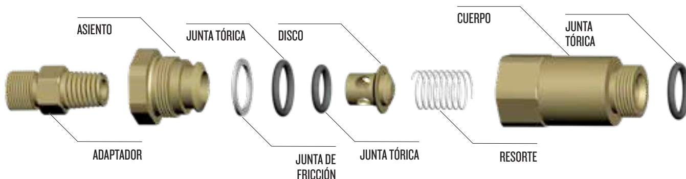
Orden correcto de montaje de la válvula antirretorno
